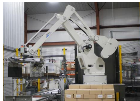
製品をパレットに移動するパレタイズロボット
